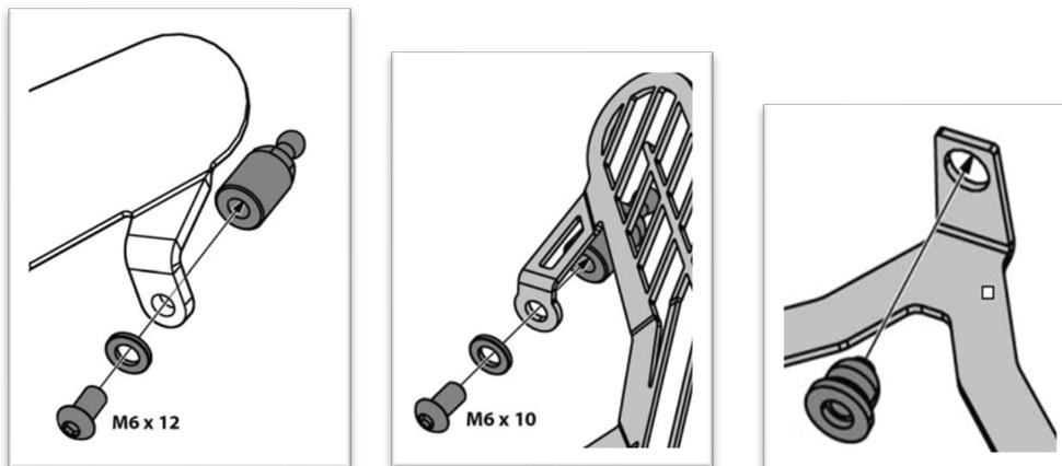
Je 3x Bolzen und je 3x Kupplung montieren / mount 3x bolts and 3x couplings
