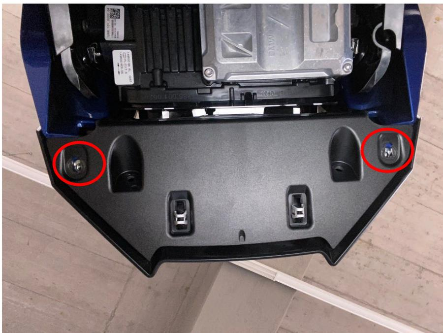
2x Schrauben lösen / 2x loosen screws
