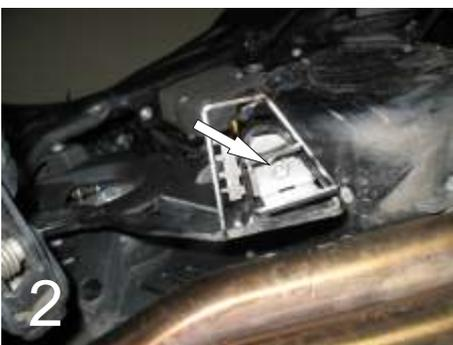
2) Unterteil wie in Bild 2 von unten in den Bremshebel schieben und mit Schraube M5x12, Scheibe M5 und Mutter M5 befestigen
