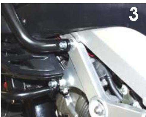
Den Bügel ansetzen und in der oberen Verschraubung mit M8x 45, in der unteren Verschraubung auf der linken Seite mit der M10 X 100 Feingewindeschraube und auf der rechten Seite unten mit der M10 x 80
